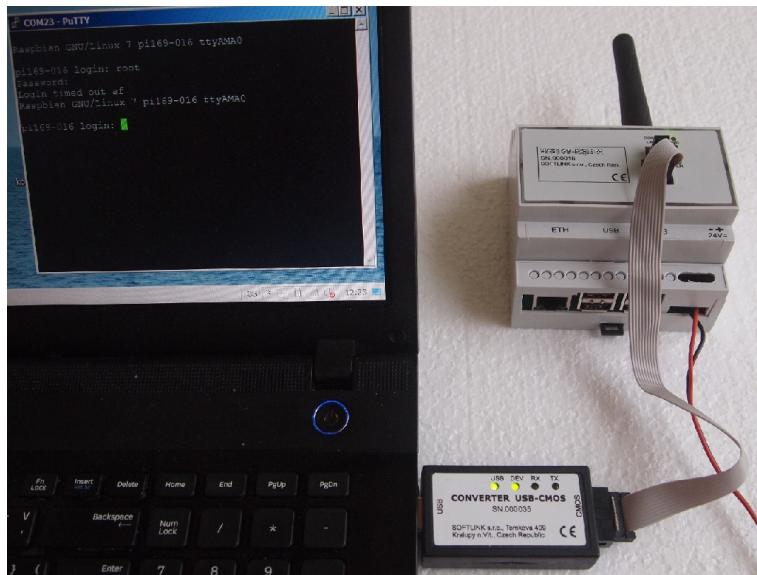
Obr. 3: Konfigurace modulu přes USB port počítače
