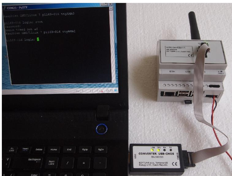
Obr. 3: Konfigurace modulu přes USB port počítače
