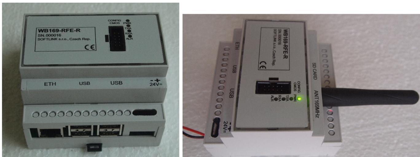
Obr. 1: Vzhled modulu WB169-RFE-R
