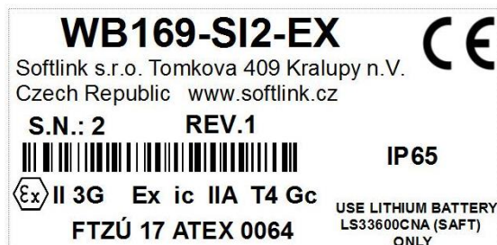
obr. 7: Výrobní štítek modemu
