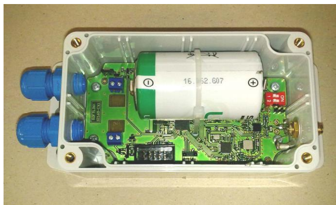
obr. 2: Pohled na otevřený modem WB169-SI2-EX
