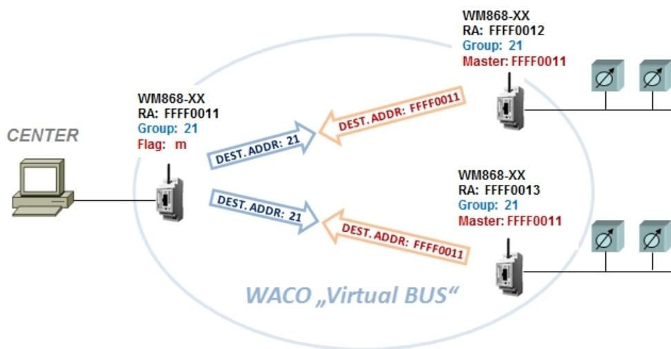
Obr. 15: Princip adresace v aplikaci „Virtual BUS“ systému WACO
