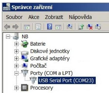
Obr. 10: Zobrazení WACO USB GateWay ve „Správci zařízení“ OS Windows
