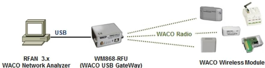
Obr. 8: Princip lokální konfigurace modulu WM868-IR20-LP-H
