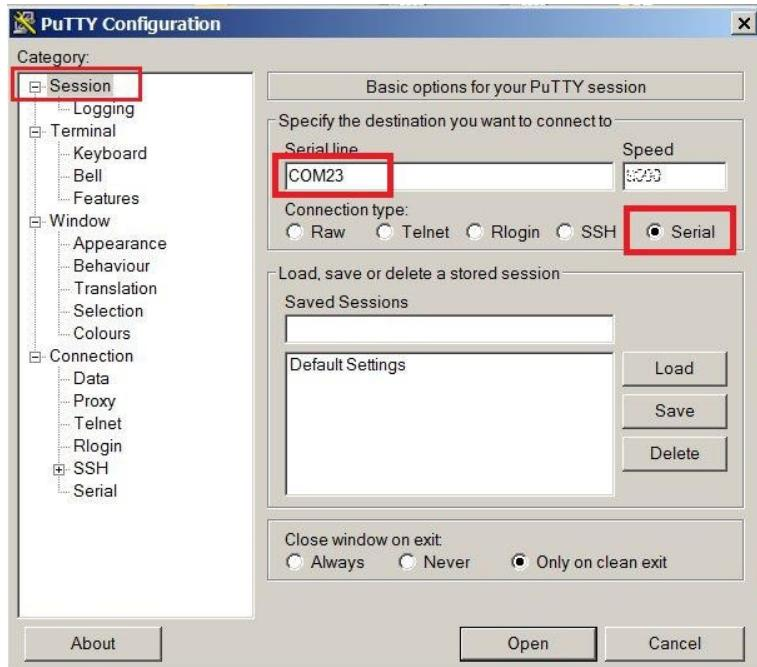
Obr. 6: Nastavení terminálu pro komunikaci po sériové lince
