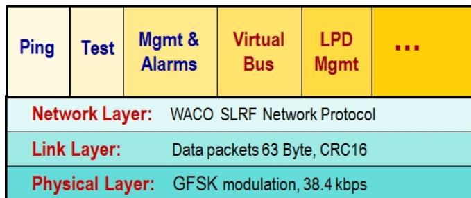
Obr. 18: Struktura komunikačních vrstev protokolu WACO SLRF
