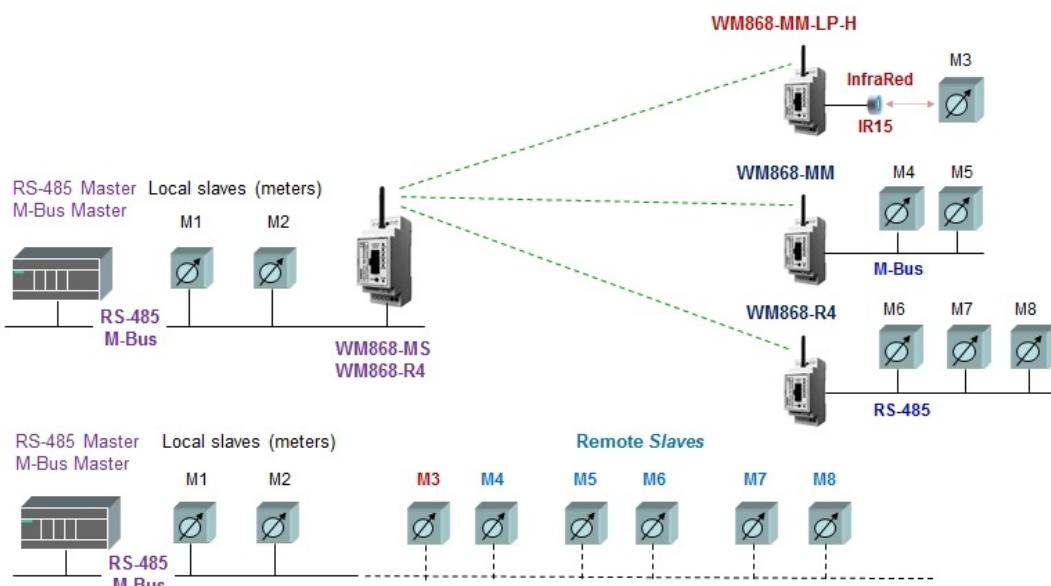
Obr. 1: Princip transparentního přenosu dat v síti WACO
