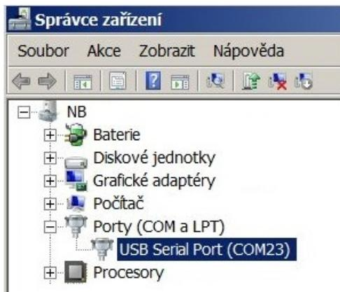
Obr. 4: Zobrazení převodníku USB-CMOS ve „správci zařízení“ systému Windows
