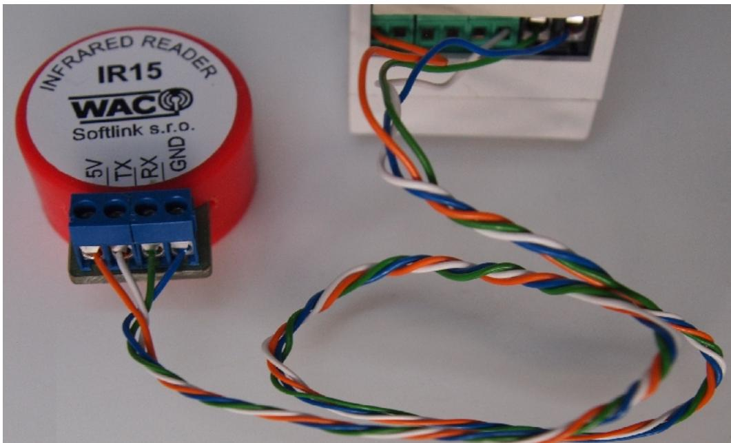
Obr. 3: Modul WM868-IR20-LP-H s připojenou optickou hlavou IR15
