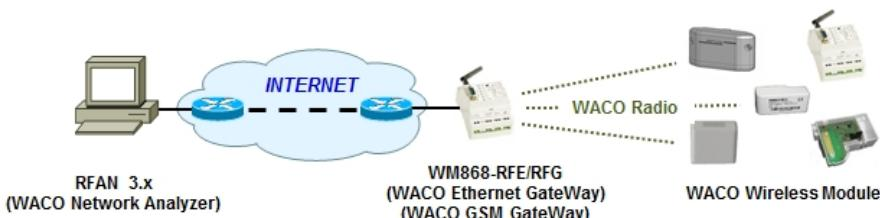
Obr. 9: Pincip vzdálené konfigurace modulu WM868-IR20-LP-H
