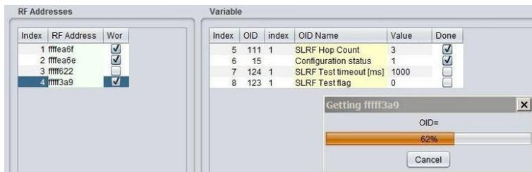
Obr. 11: Průběh získávání aktuálních hodnot vybraných proměnných vybraného modulu příkazem „GET“
