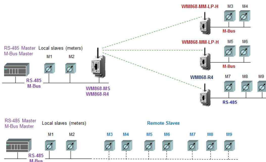
Obr. 1: Princip transparentního přenosu dat v síti WACO
