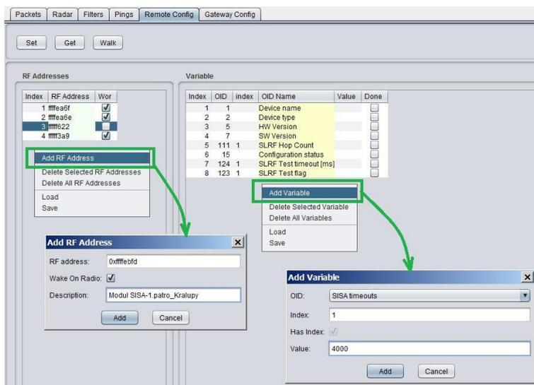
Obr. 10: Zavedení zařízení a proměnných do okna dálkové konfigurace
