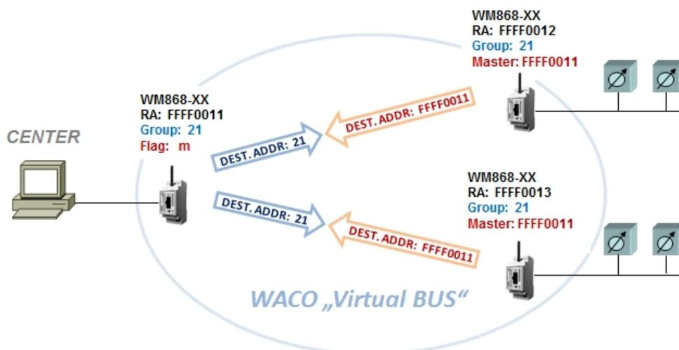
Obr. 14: Princip adresace v aplikaci „Virtual BUS“ systému WACO
