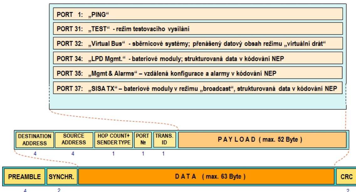
Obr. 18: Struktura datové zprávy systému WACO
