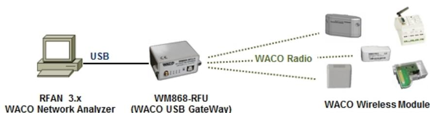
Obr. 7: Princip lokální konfigurace modulu WM868-MM-LP-H
