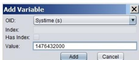
Obr. 15: Nastavení systémového času radiovou cestou
