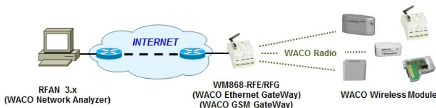
Obr. 8: Pincip vzdálené konfigurace modulu WM868-MM-LP-H
