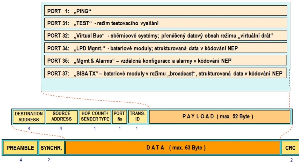
Obr. 18: Struktura datové zprávy systému WACO
