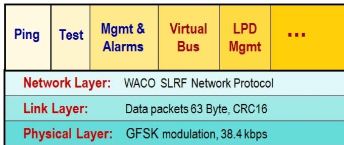
Obr. 17: Struktura komunikačních vrstev protokolu WACO SLRF
