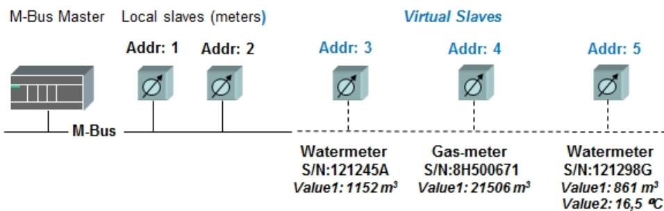
Obr. 16: Princip konverze dat sběrné jednotky
