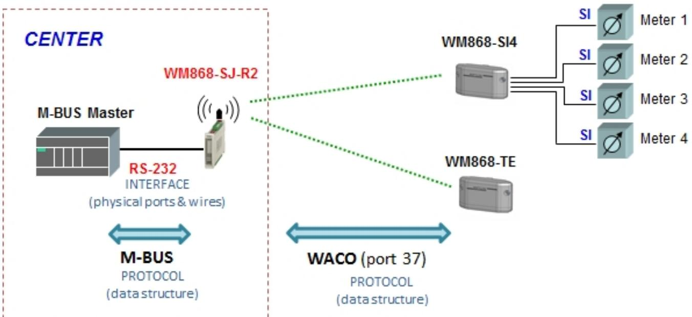
Obr. 1: Princip konverze dat sběrné jednotky WM868-SJ-R2
