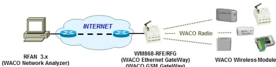
Obr. 8: Pincip vzdálené konfigurace modulu WM868-SJ-R2
