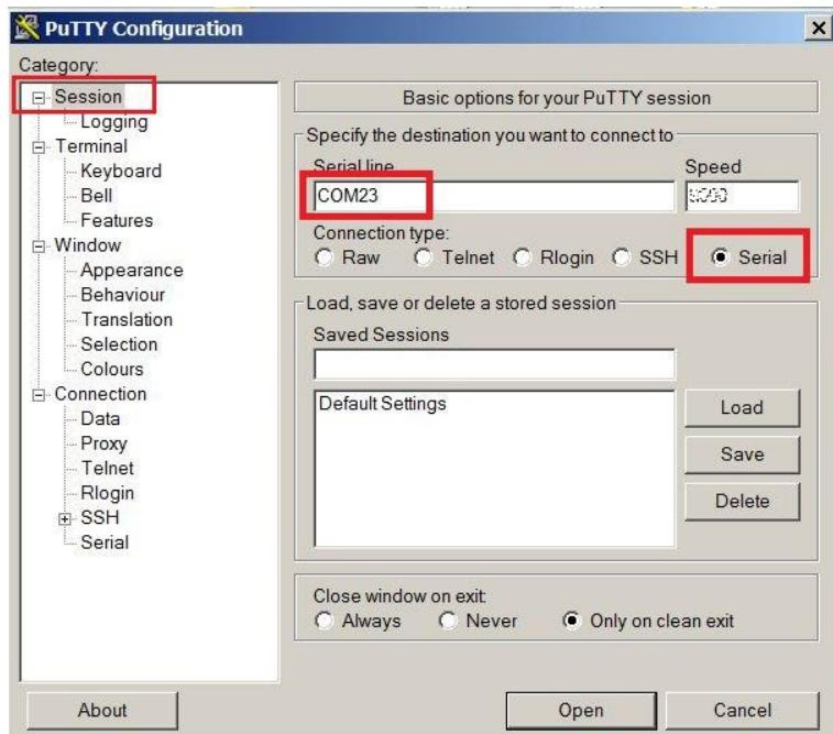
Obr. 5: Nastavení terminálu pro komunikaci po sériové lince
