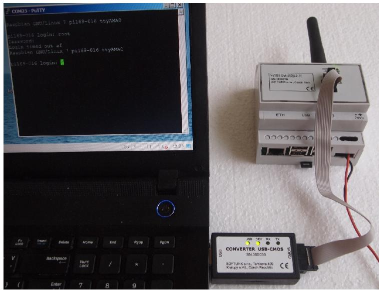
Obr. 4: Konfigurace modulu přes USB port počítače
