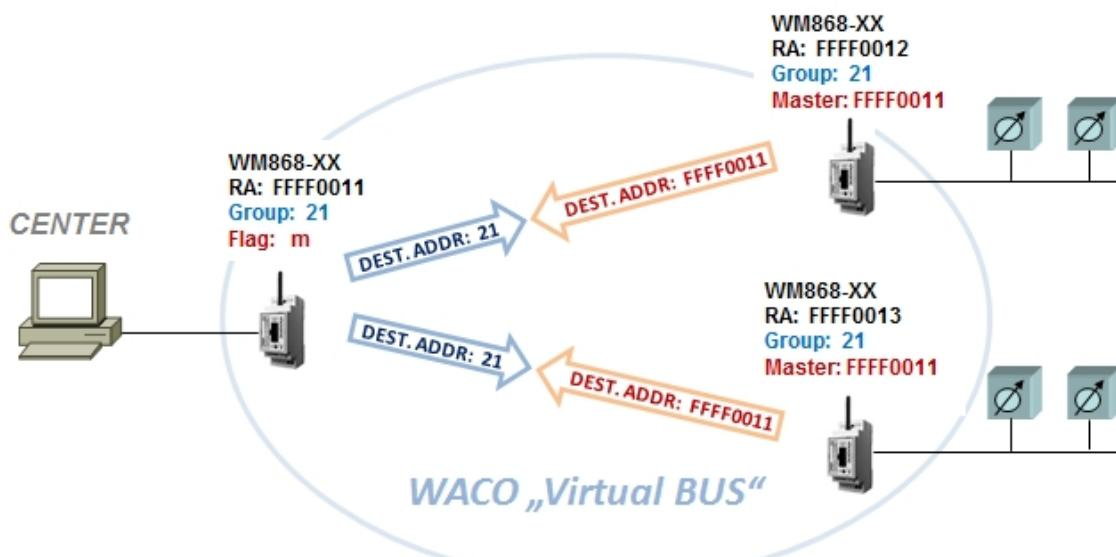
Obr. 14: Princip adresace v aplikaci „Virtual BUS“ systému WACO
