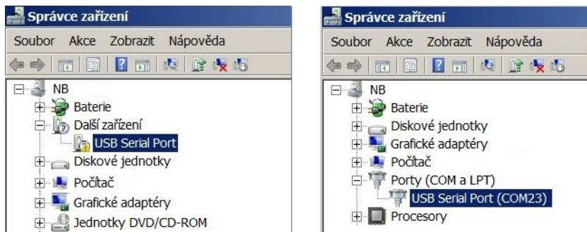
Obr. 13: Zobrazení převodníku bez ovladače ve „Správci zařízení“ systému Windows
