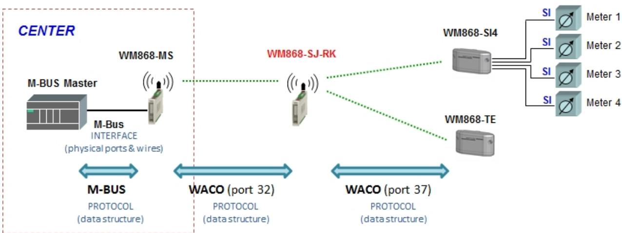
Obr. 1: Princip konverze dat sběrné jednotky WM868-SJ-RK
