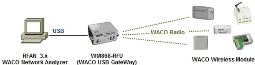
Obr. 7: Princip lokální konfigurace modulu WM868-TI3
