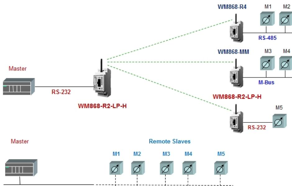
Obr. 1: Princip transparentního přenosu dat v síti WACO
