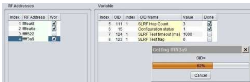
Obr. 4. Průběh získávání aktuálních hodnot vybraných proměnných vybraného modulu příkazem „GET“
