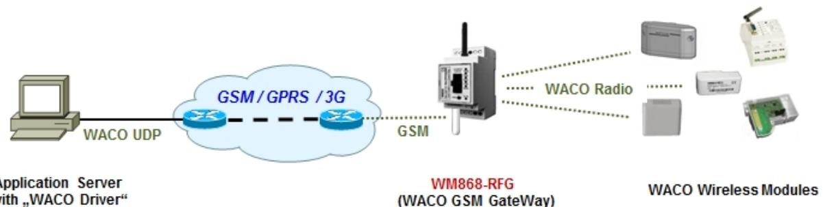
Obr. 1: Princip použití komunikační brány „WACO GSM GateWay“ v síti WACO
