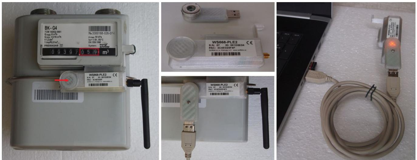
Obr. 12: Montáž a konfigurace modulu WS868-PLE2
