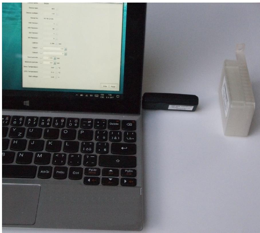
Obr. 2: Konfigurace modulu přes optický převodník
