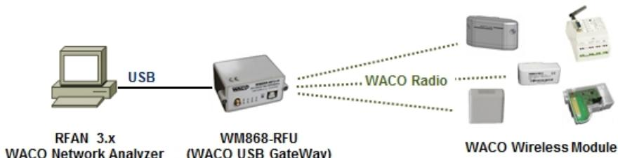
Obr. 7: Princip lokální konfigurace modulu
