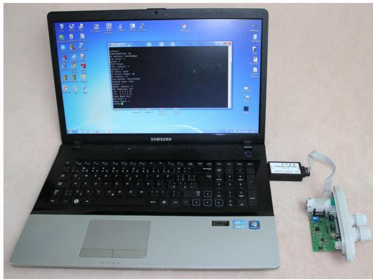
Obr. 4: Konfigurace modulu přes USB port počítače
