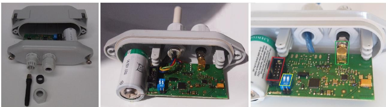
Obr. 23: Detailní pohled na modul WM868-TE-H (vlevo) a WM868-TES-H (vpravo)
