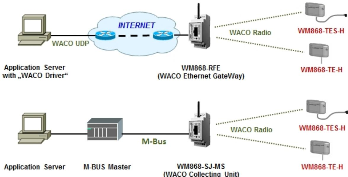
Obr. 1: Princip přenosu dat z modulu WM868-TE-H/WM868-TES-H
