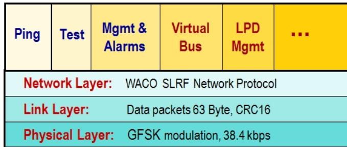
Obr. 19: Struktura komunikačních vrstev protokolu WACO SLRF
