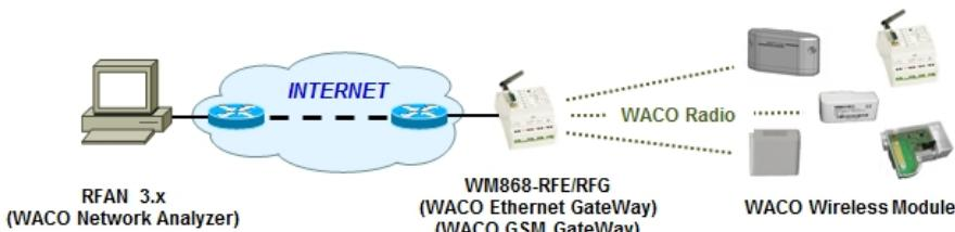
Obr. 8: Pincip vzdálené konfigurace modulu
