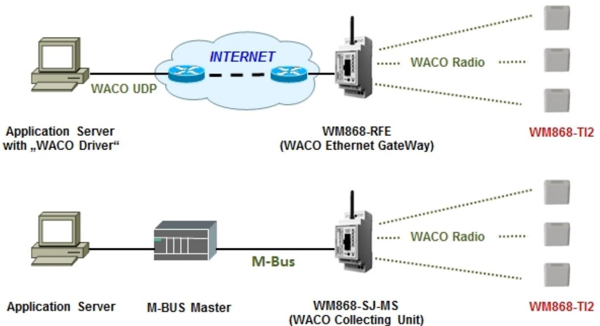
Obr. 1: Princip přenosu dat z modulu WM868-TI2
