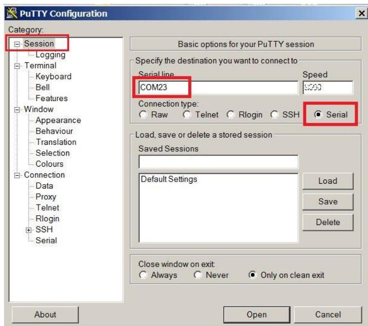
Obr. 5: Nastavení terminálu pro komunikaci po sériové lince
