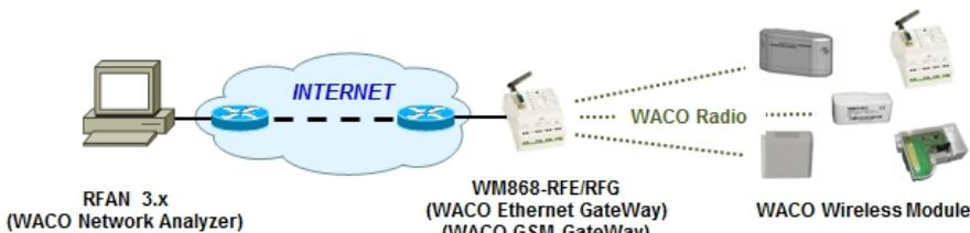
Obr. 8: Pincip vzdálené konfigurace modulu
