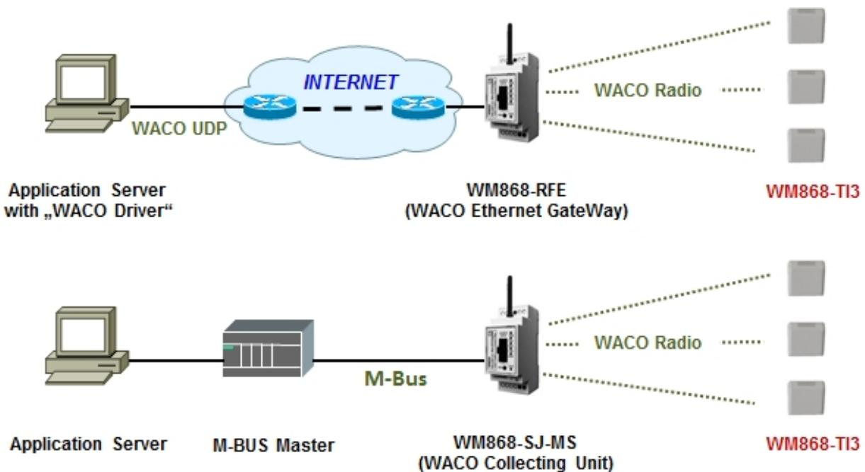
Obr. 1: Princip přenosu dat z modulu WM868-TI3
