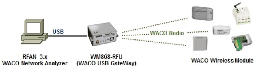
Obr. 7: Princip lokální konfigurace modulu
