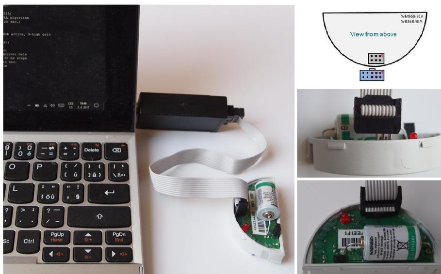
Obr. 4: Konfigurace modulu přes USB port počítače
