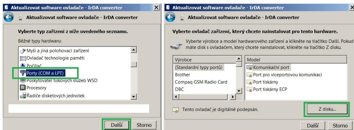
Obr. 14: Postup při výběru driveru z počítače
