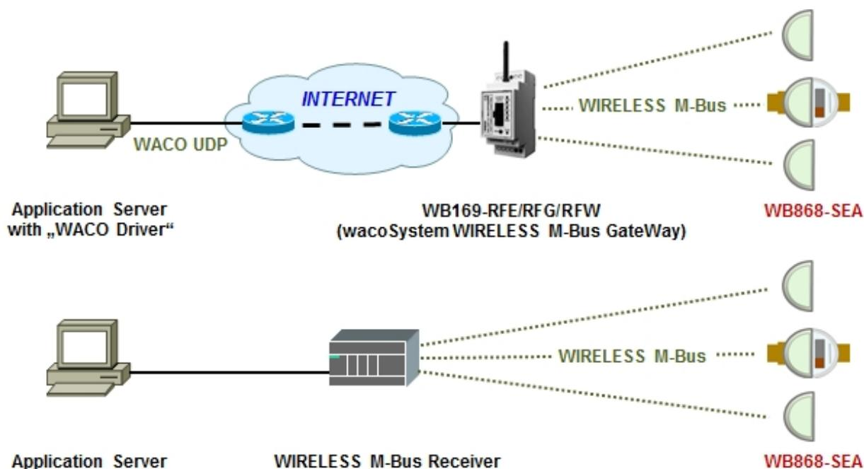
Obr. 1: Princip přenosu dat z modulu WM868-SEA
