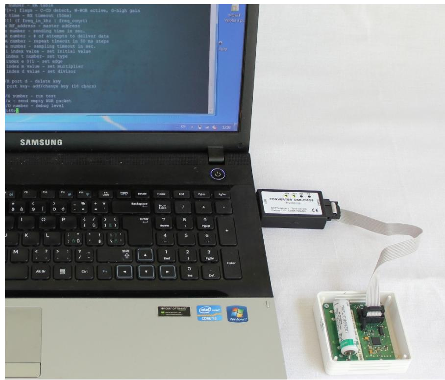
Obr. 3: Konfigurace modulu přes USB port počítače
