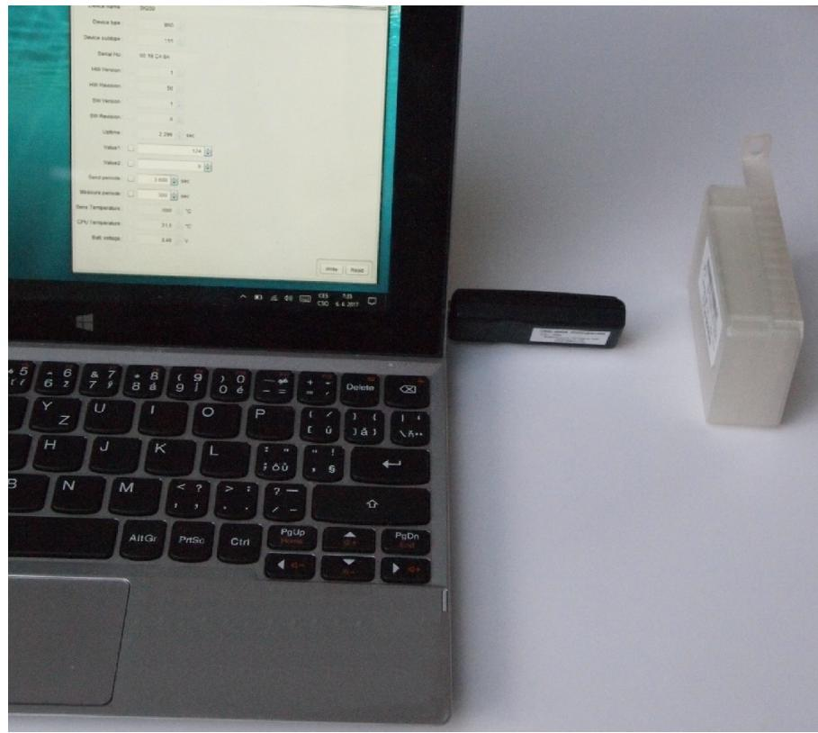
Obr. 6: Konfigurace modulu přes optický převodník
