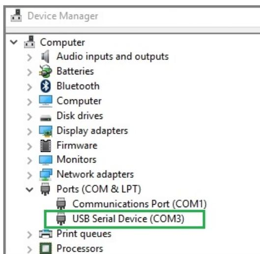
Obr. 3: Zobrazení optického převodníku ve „správci zařízení“ systému Windows
