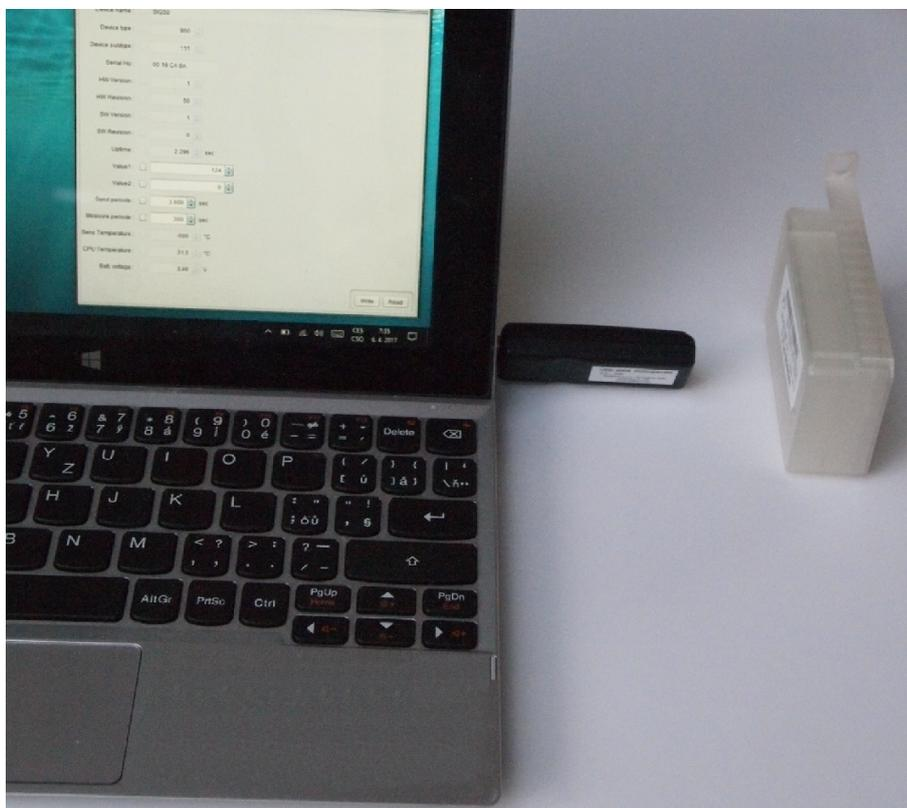
Obr. 2: Konfigurace modulu přes optický převodník
