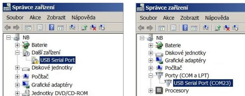
Obr. 7: Zobrazení zařízení bez ovladače ve „Správci zařízení“ systému Windows
