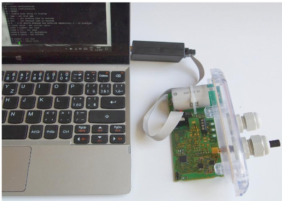
Obr. 3: Konfigurace modulu přes USB port počítače
