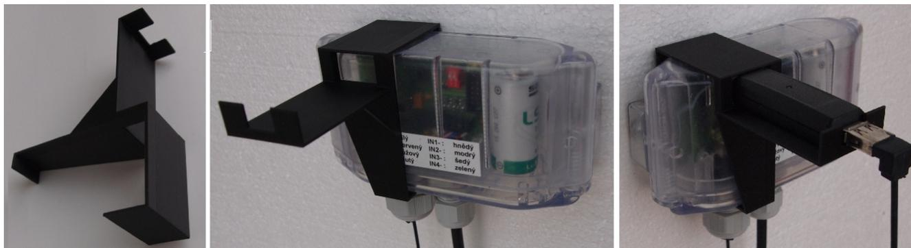
Obr. 11: Uchycení optického převodníku do přípravku
