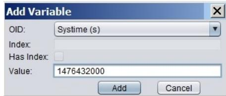
Obr. 18: Nastavení systémového času radiovou cestou
