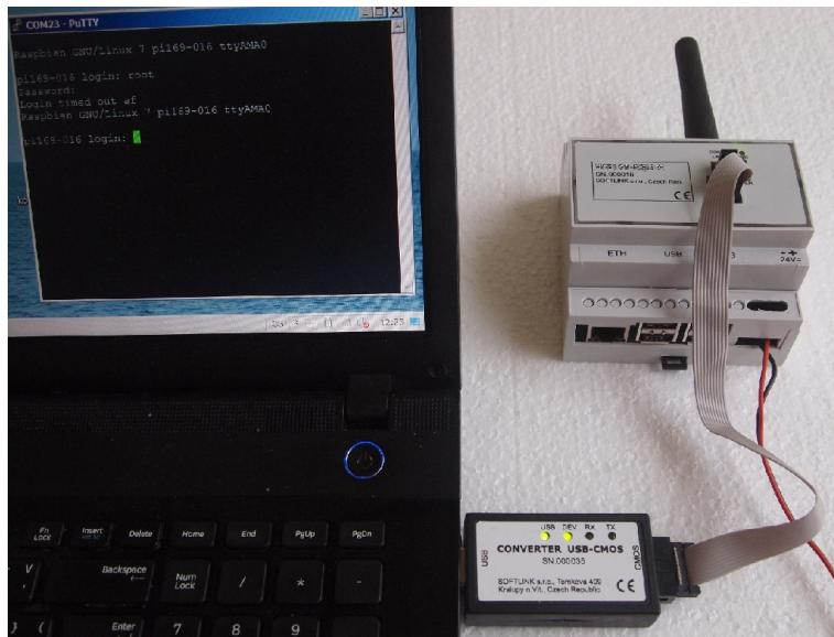
Obr. 5: Konfigurace modulu přes USB port počítače
