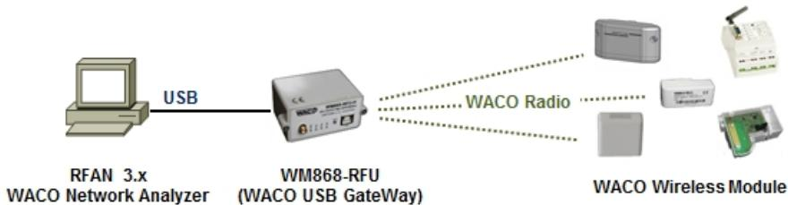
Obr. 7: Princip lokální konfigurace modulu
