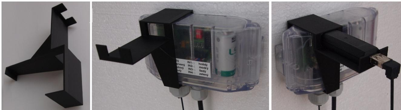
Obr. 6: Uchycení optického převodníku do přípravku
