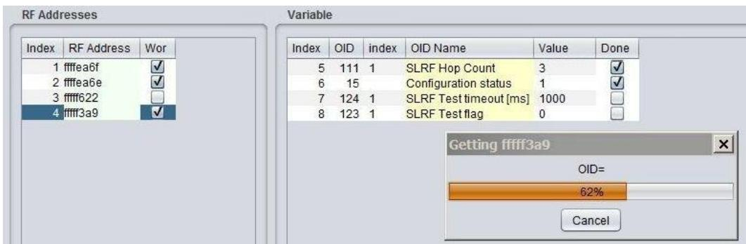
Obr. 18: Průběh získávání aktuálních hodnot vybraných proměnných vybraného modulu příkazem „GET”
