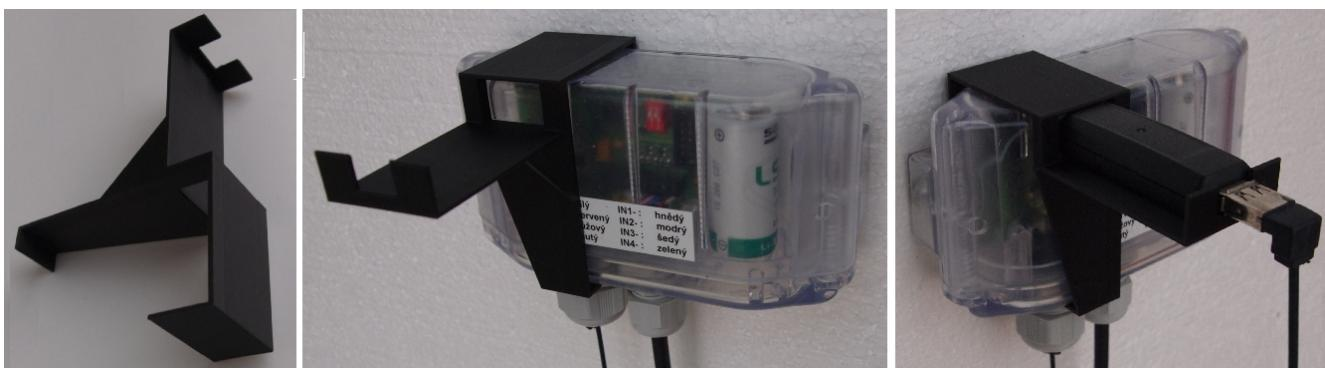
Obr. 11: Uchycení optického převodníku do přípravku
