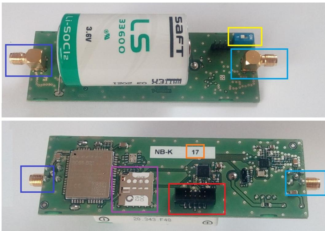
Obr. 8: Detail desky plošného spoje modulu NB-K430
